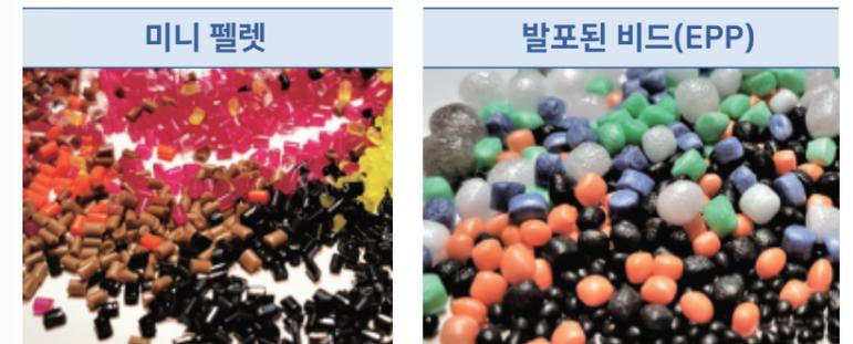
전통적인 EPP 생산 방식은 배치 발포(batch foaming process)로 단단한 R-PP 미니 펠릿 속에 CO2 발포제를 주입시키는 방식입니다.
